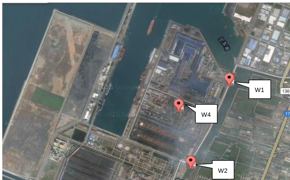
圖 1.4-7 放流口、排放口、廠區放流口各一點共 3 點（W1 排放口上游、W2 排放口下游、W4 廠區放流口）
