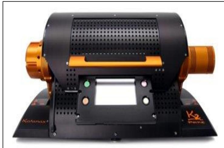
自動熔融機(XRF fusion machine)
